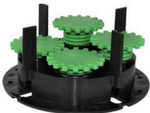
Stelzlager, Vollstück, höhenverstellbar von 35-55 mm, ergibt 2 mm breite Fugen. Höhe Fugenstege kann individuell z.B. mit einem Seitenschneider gekürzt werden. Rand- und Eckstücke können herausgebrochen, bzw. geschnitten werden. (Nur für Granitkeramik-Platten geeignet)
