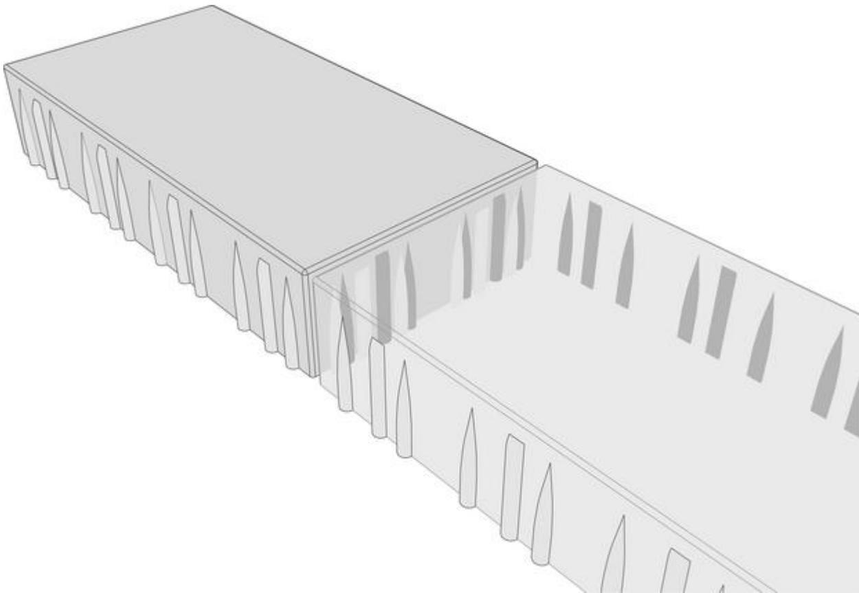
Unsichtbare Verzahnung der Steinflanken nach dem Reißverschluss-Prinzip
