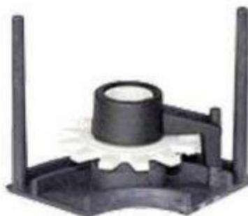
**Plots**, élément de bord, réglable en hauteur de 46-66 mm. Le résultat : des joints de 6 mm de large
