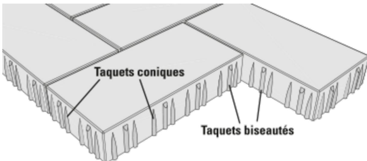
L'alignement symétrique des taquets KANNtec permet la quasi-totalité des poses courant
