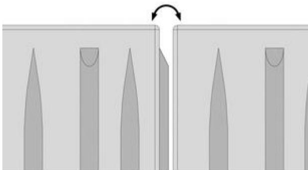
Les taquets multiple limitent les mouvements de bascule et stabilisent l'ouvrage
