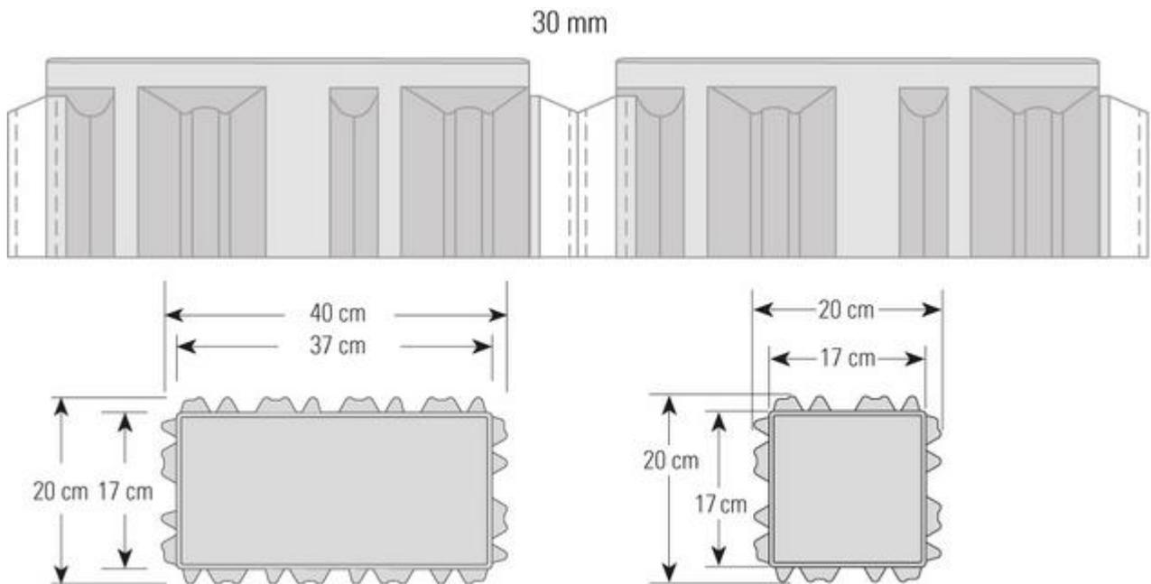
MultiTec-Eco avec taquets KANNtec10 joint large drainant 30 mm
