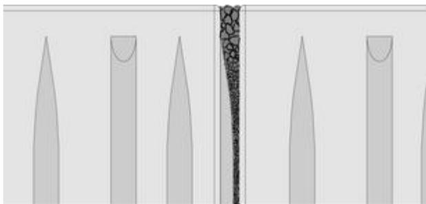
Le matériau de jointoiement coule en entonnoir vers la base où il est bloqué et ne peut s'échapper dans le lit de pose
