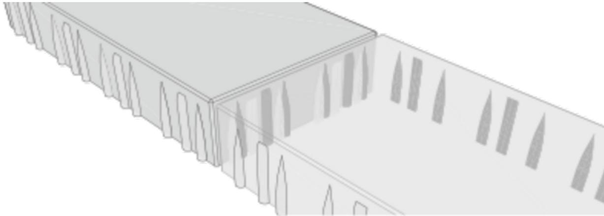
Emboîtement des pavés invisible selon le principe d'une fermeture éclair
