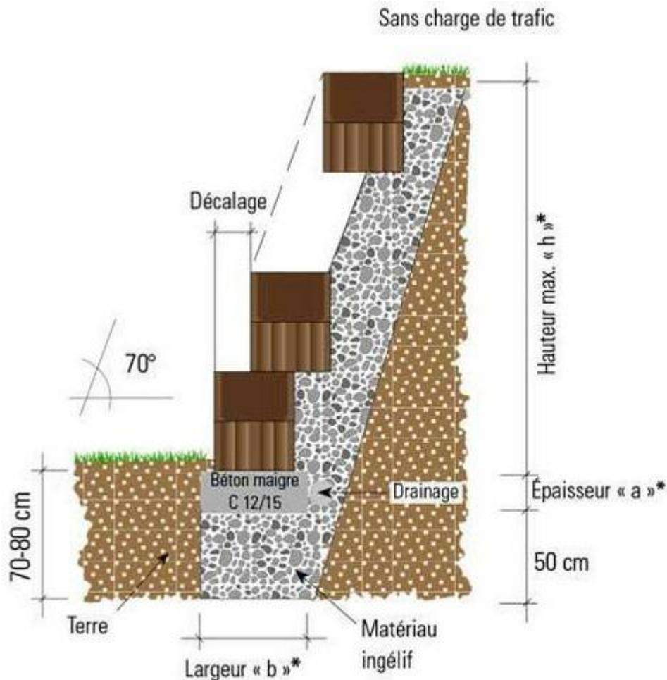
**Construire deux jardinières situées l'une au-dessus de l'autre avec un double décalage a fait ses preuves dans le cas des systèmes pour talus avec une inclinaison de 70°. Les espaces ainsi créés pour les plantes leur permettent de pousser plus rapidement.**
