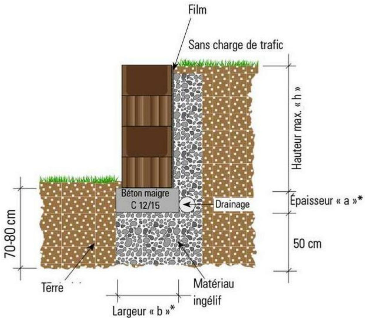
**mur vertical avec remplissage à l'arrière**
