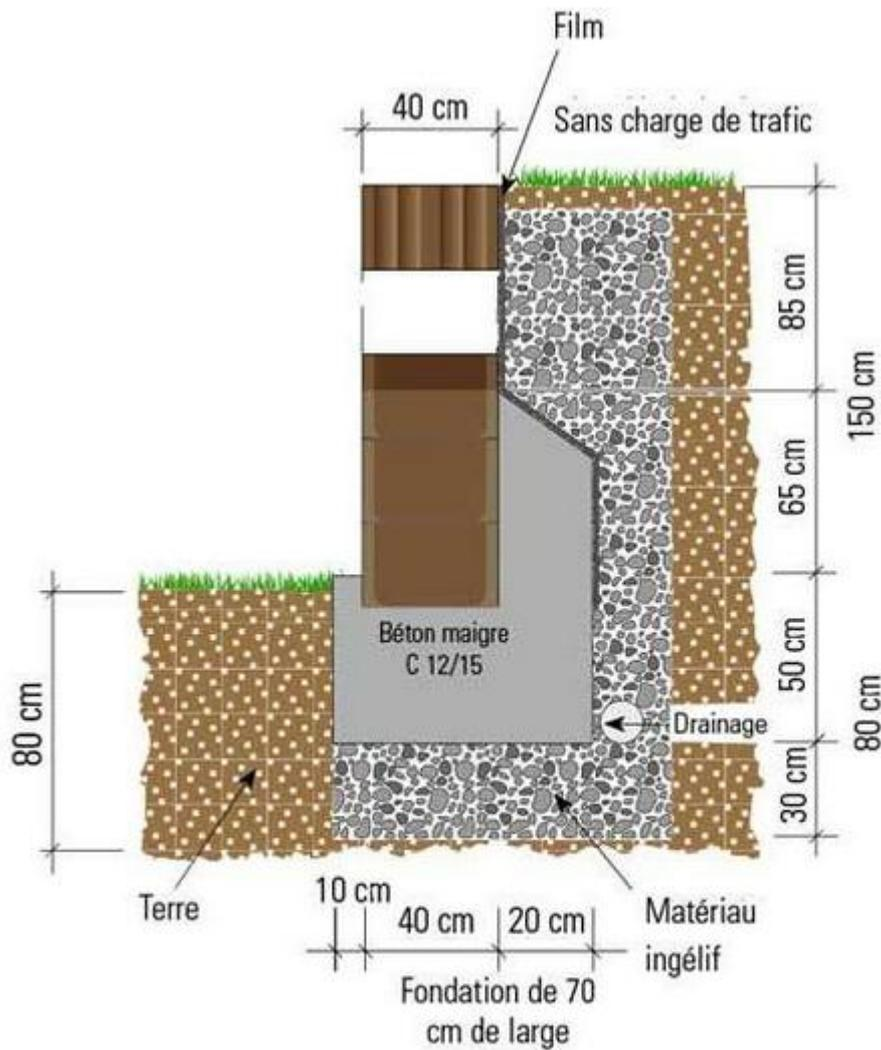
**Des hauteurs de construction plus élevées (max. 1,50 m) sont possibles avec Gala Flair en remplissant les éléments avec du béton maigre.**
