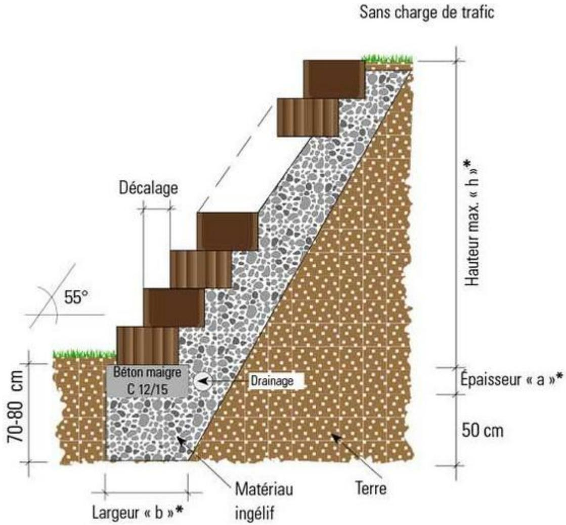
**Un angle de construction de 55° permet de réaliser des constructions plus hautes.**
