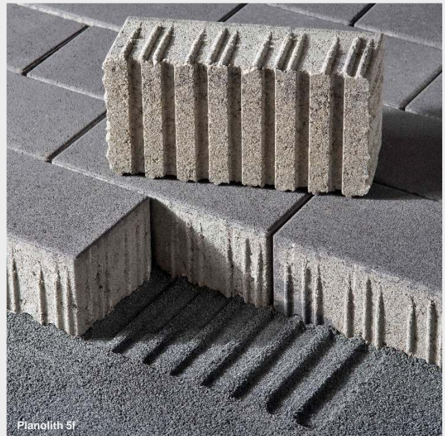
Revêtement lavé, mini-chanfrein R5/2mm, écarteurs latéraux et stries en sous-face
