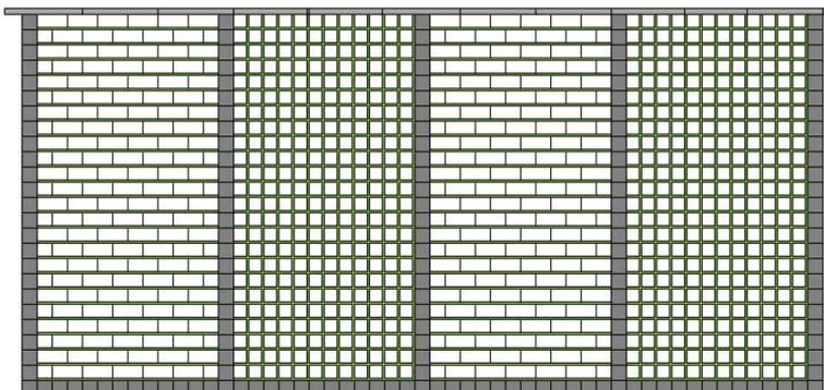
Stationnement avec MultiTec-Linear et MultiTec-Éco 20x20x8 cm, teinte gris, séparation et bandes de rives avec MultiTec 20x20x8cm, teinte Anthracite
