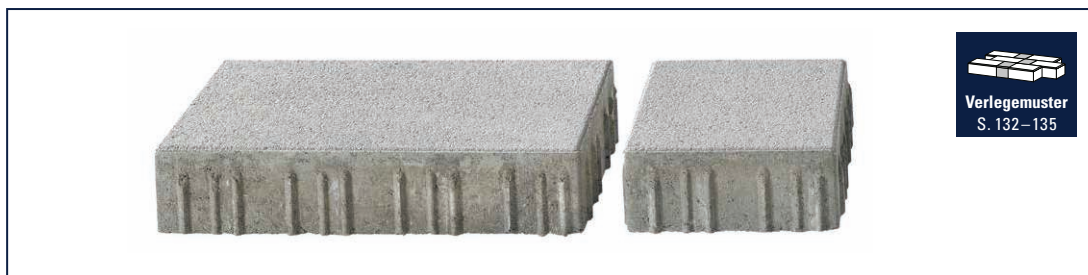
kugeligestrahlt, Minifase R5/2 mm, KANNtec 10 -Verbundnocken
