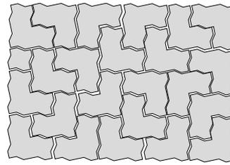
Anordnung der Uni-Coloc Ankerverbundsteine in einer Lage. (Zur besseren Erkennbarkeit der Fugen zwischen den Steinen sind die Scheinfugen auf den Steinen nicht dargestellt.)
