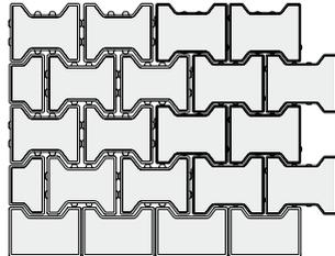
Doppel-T-Aqua und Doppel-T-Verbundpflaster in kombinierter Verlegung
