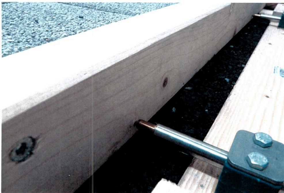
Bild 7: Wegaufnehmer am Pflasterrahmen
