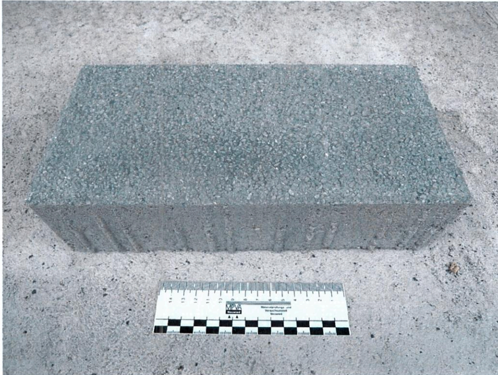
Bild 8: Planolith KANNtec16 – 32/16/8 ohne Rillen - Oberseite
