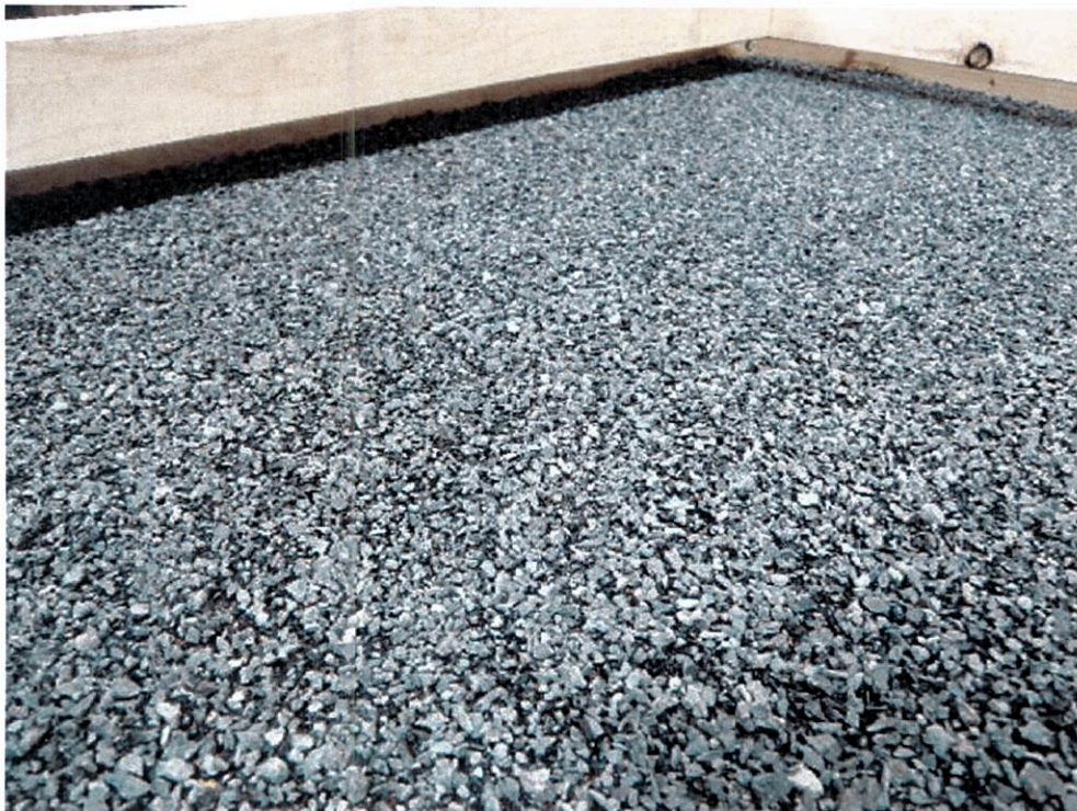
Bild 2: „Besandeter“ Boden des Bettungsrahmens
