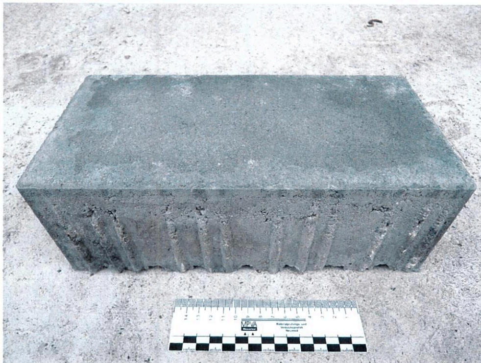
Bild 10: Planolith KANNtec16 – 32/16/10,8 mit Rillen - Oberseite
