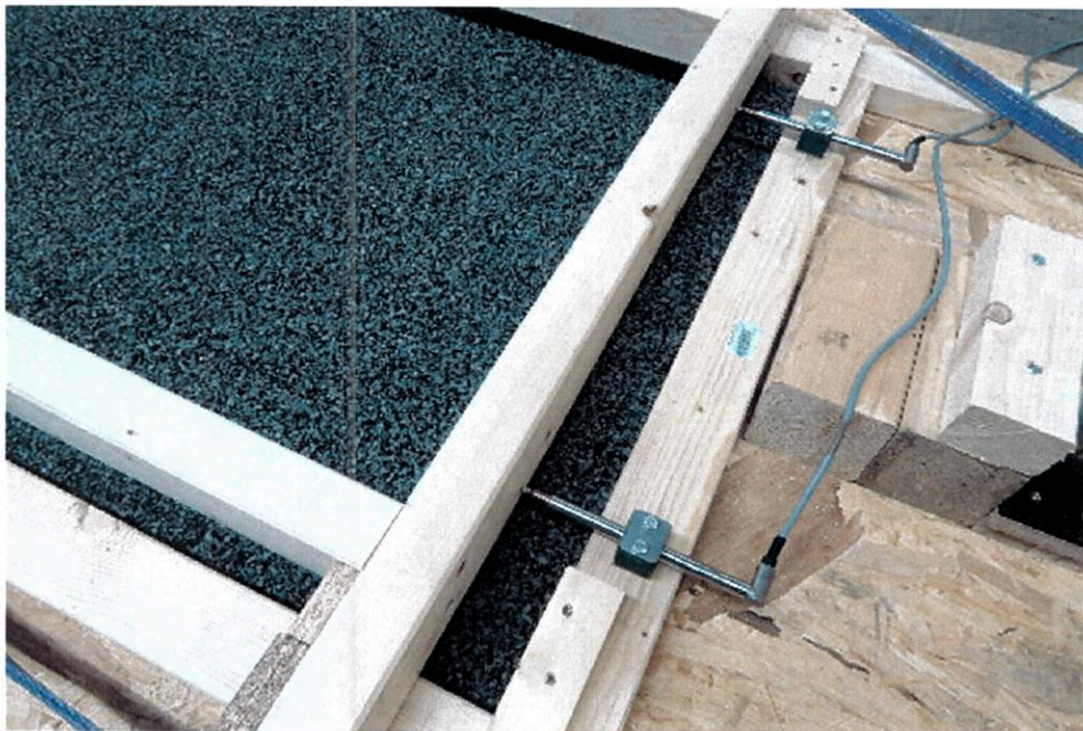
Bild 7: Wegaufnehmer am Pflasterrahmen
