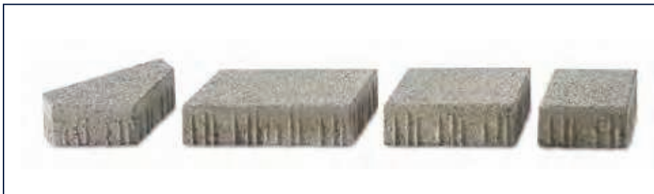
wassergestrahlt, Minifase R5/2 mm, KANNtec®-Verbundnocken
